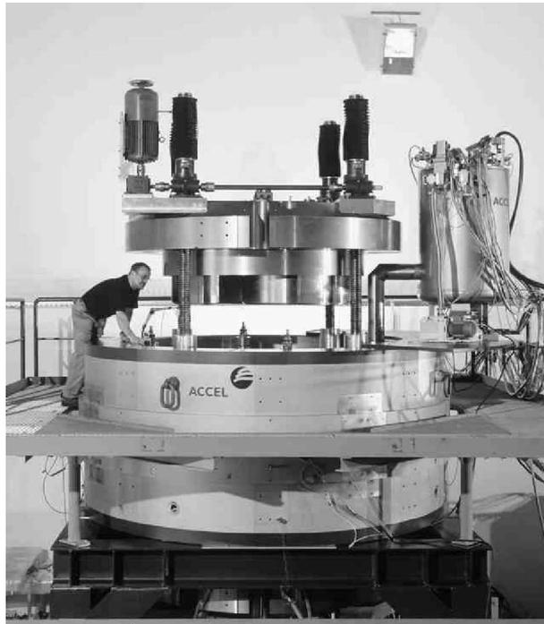
**Abbildung 27: Externer Versorgungskryostat am Beispiel eines supraleitenden Zyklotrons**
